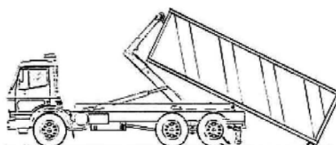
2° SOLLEVAMENTO CONTAINER CON STABILIZZATORE ABBASSATO
